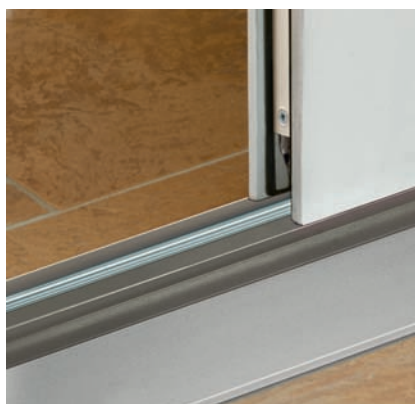
Die Bodenschwelle mit einer Stufe von 19 mm ermöglicht einen barrierefreien Durchgang und gilt als behindertengerecht nach DIN 18025.
